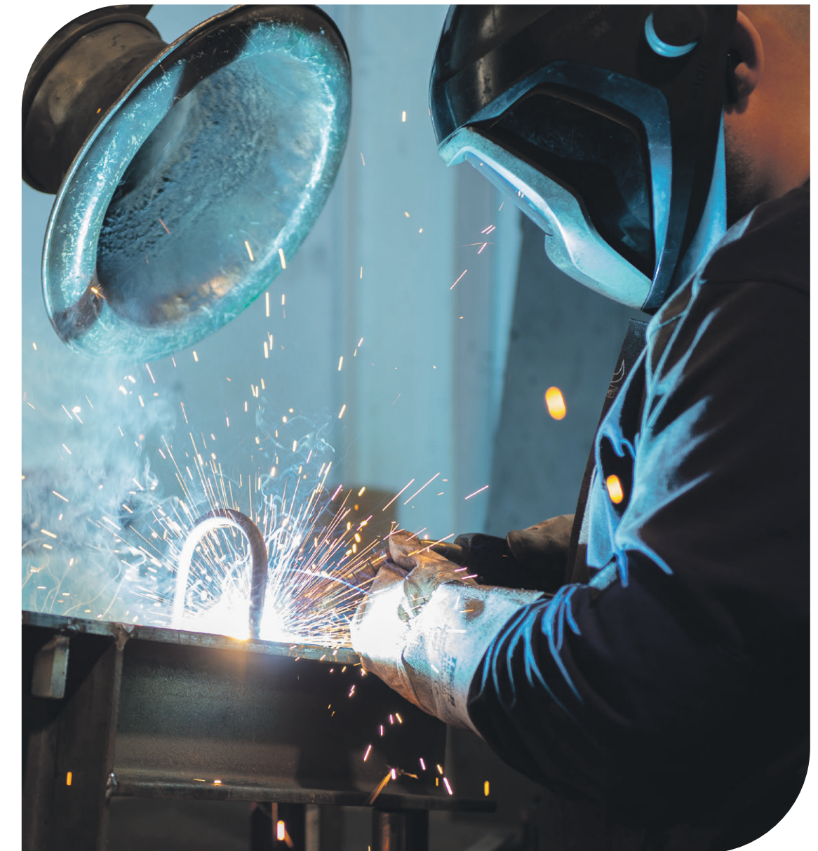
Svejsning har altid været en fundamental ting hos UNI-TEK, og virksomheden har indarbejdet svejserutiner i hverdagen i henhold til standarden EN 1090.
