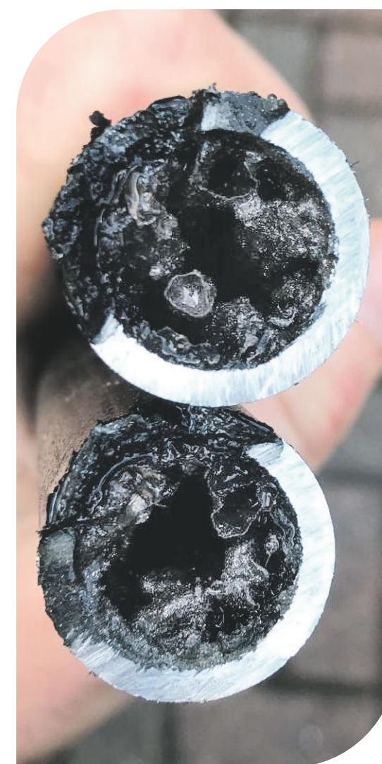
Sådan ser et vandrør ud fyldt med biofilm, hvor bakterier som Legionella vokser. Ved du, hvad der gemmer sig i dine rør?
