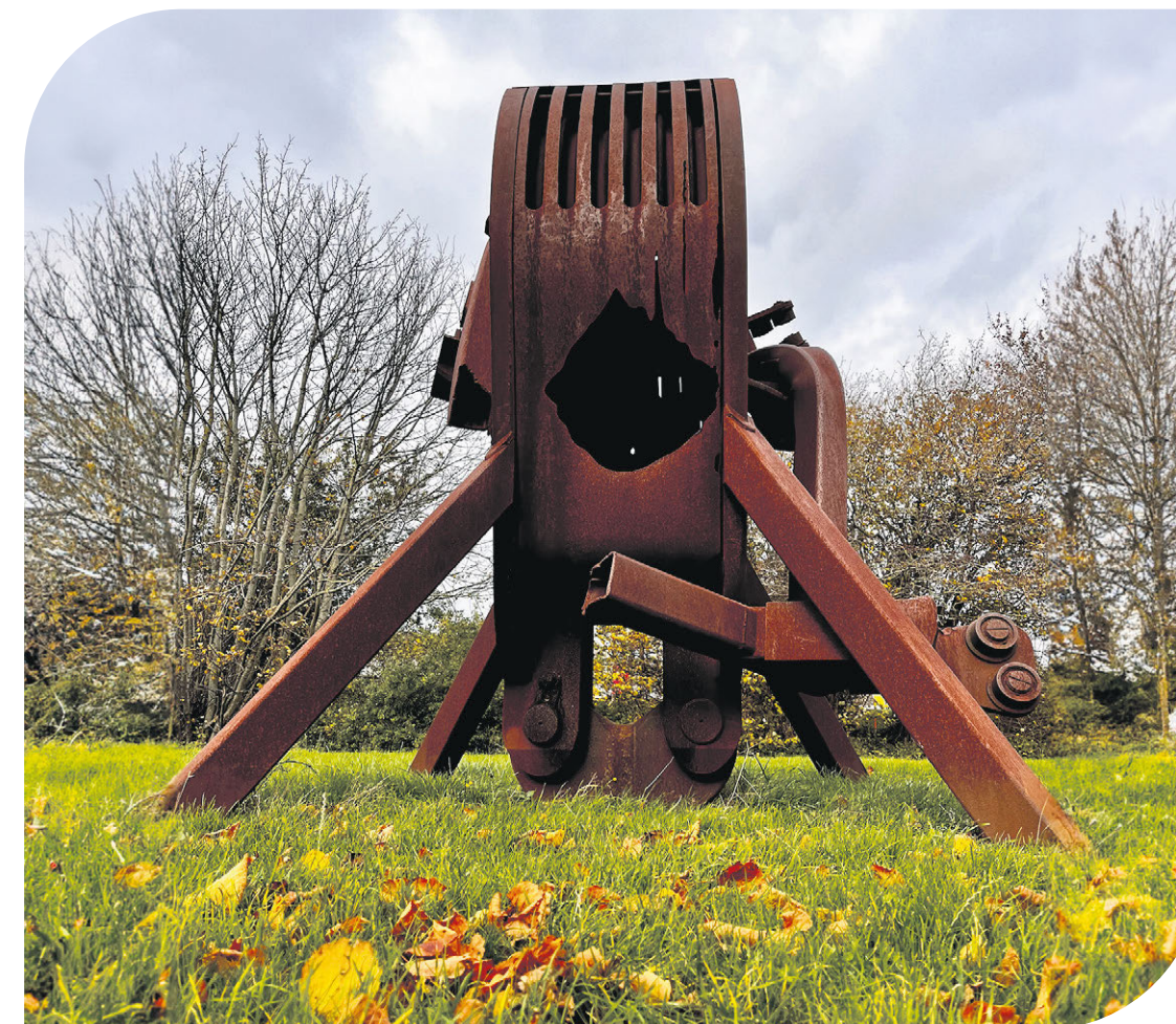
Travel Block fra ulykken på Maersk Explorer i 1977 er udstillet hos Maersk Training, Svendborg - som et symbol på, hvilke kræfter man er oppe imod.
